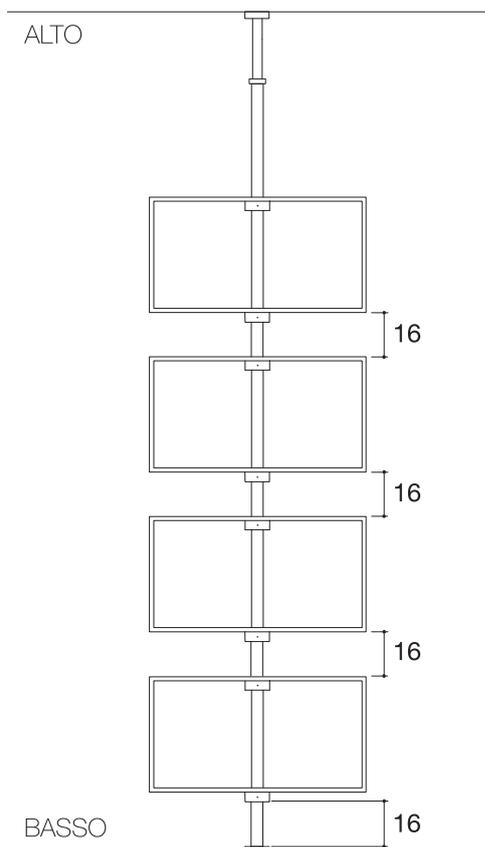
Ultimare il montaggio e posizionare la libreria secondo le istruzioni di montaggio Ubiqua pag. 8 colonna a telaio girevole fissata a parete oppure a pagina 12 colonna a telaio girevole fissata tra pavimento e soffitto.
