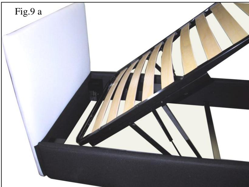
Posizionare la rete con i tre fori laterali sui meccanismi aperti in corrispondenza dei fori sui meccanismi stessi ed unire il tutto con le viti TBEI M8 x 50 e i dadi autobloccanti M8.(Fig. Fig. 9 a-b)
