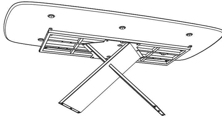
Posizionare il piano sagomato sopra il telaio. Fissarlo al telaio utilizzando i fori e le viti indicate qui sotto. Fissare prima le due viti centrali ● senza stringere eccessivamente. Ora procedere all'inserimento dei 4 regolatori nei fori posizioni alle estremità ●. Quando il piano risulta essere dritto ultimare il fissaggio mediante l'inserimento delle 4 viti ●. Stringere ora le viti centrali.
