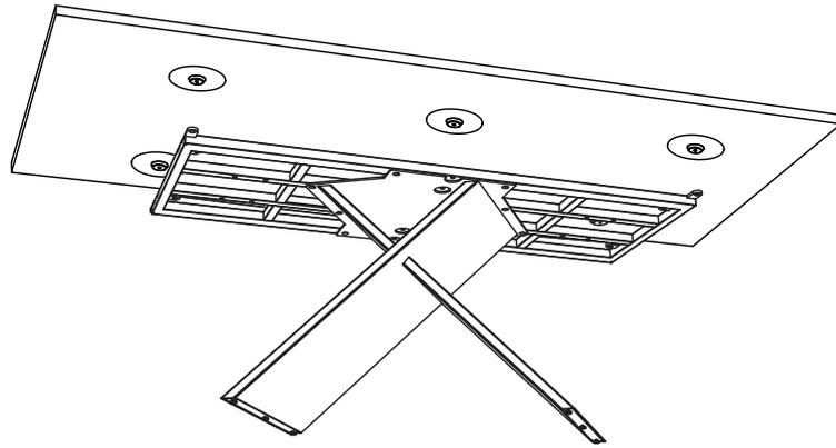
Posizionare il piano rettangolare sopra il telaio. Fissarlo al telaio utilizzando i fori e le viti indicate qui sotto. Fissare prima le due viti centrali ● senza stringere eccessivamente. Ora procedere all'inserimento dei 4 regolatori nei fori posizioni alle estremità ●. Quando il piano risulta essere dritto ultimare il fissaggio mediante l'inserimento delle 4 viti ●. Stringere ora le viti centrali.
